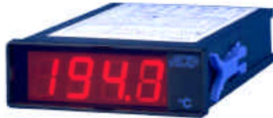
Les indicateurs TNE 2 peuvent être raccordés à des capteurs de température. Ils affichent directement la température en °C. Ces appareils industriels sont livrés en standard avec un bornier à vis débrochable et une sortie analogique. L'affichage, très lisible, est constitué de LED rouges (vertes ou jaunes en option).
