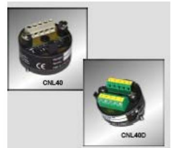
Les CNL40... sont des transmetteurs tête de sonde technique 2 fils universel pour mesure de température et process. Le CNL40igH est entièrement compatibles HART, la communication sous protocole HART s'effectue directement sur la boucle de sortie 4/20 mA par l'intermédiaire d'une console de programmation HART standard.
