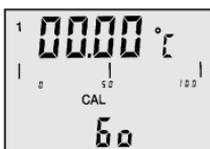
ligne d'affichage pour la valeur mesurée 1, dans la 2<sup>ème</sup> ligne apparaît **dP** pour le point décimal.
