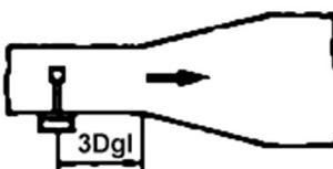
La sonde doit être placée devant les diffuseurs.
