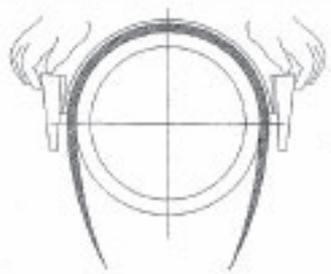
Placez la partie inférieure du collier sous le tuyau et accrochez-le sans serrer sur l'autre support à vis avec l'étrier de fixation libre.
