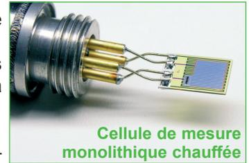
Cellule de mesure monolithique chauffée
